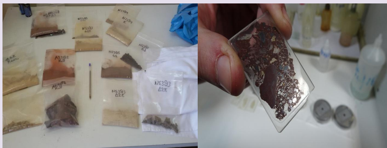
Εικ. Προετοιμασία δειγμάτων Λατερίτης σε λεπτή τομή για ενόργανες αναλύσεις.
