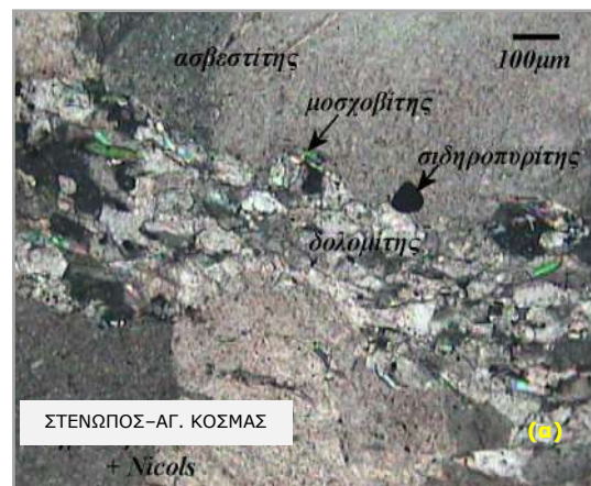
Εικόνα 1: Υφή επιφάνειας θραυστού υλικού (α). Προϊόν θραύσης bulk δείγματος στα -25mm (β).
