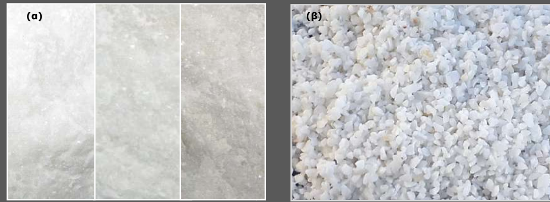
Εικόνα 1: Υφή επιφάνειας θραυστού υλικού λευκού και υπόλευκων μαρμάρων της περιοχής 'ΚΕΧΡΟΚΑΜΠΟΣ' (α). Προϊόν θραύσης λευκού bulk δείγματος (-5,0mm+2,5mm) (β).
