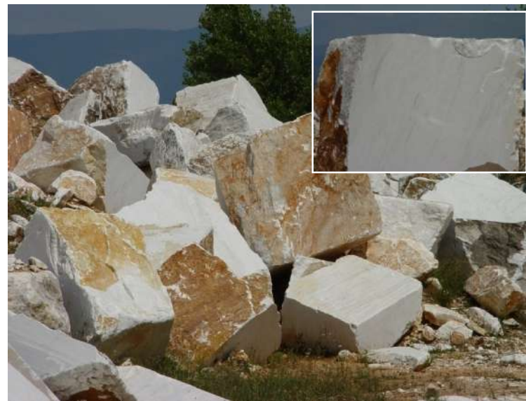
Εικόνα 3: Εξορυκτικά απόβλητα σε λατομείο στον Κεχροκάμπο. Κοντινή άποψη απορριφθέντος ογκομάρμαρου (επίσκεψη Ι.Γ.Μ.Ε., 2014).
