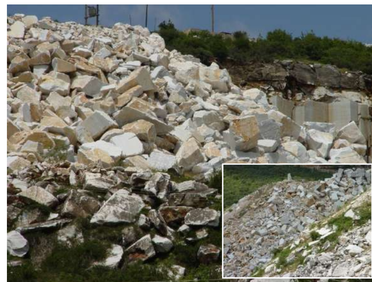
Εικόνα 3: Σωρός εξορυκτικών αποβλήτων (ξωφάρια και λατύπη) σε ενεργό λατομείο στον Αγ. Κοσμά. Στη λεπτομέρεια, απόθεση σε πλαγιά.
