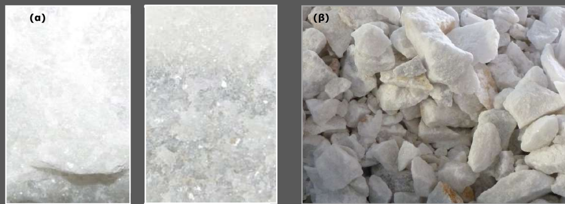
Εικόνα 1: Υφή επιφάνειας θραυστού υλικού (α). Προϊόν θραύσης bulk δείγματος στα -25mm (β).
