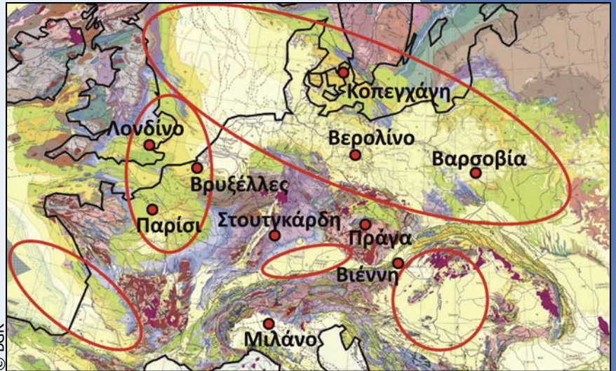
Σχήμα 2 Γεωλογικός Χάρτης της Ευρώπης που απεικονίζει τη θέση των κύριων ιζηματογενών λεκανών (κόκκινα ελλειψοειδή), όπου μπορούν να εντοπιστούν κατάλληλοι ταμιευτήρες για αποθήκευση CO 2 (με βάση το Γεωλογικό Χάρτη της Ευρώπης, κλίμακας 1:5.000.000).
