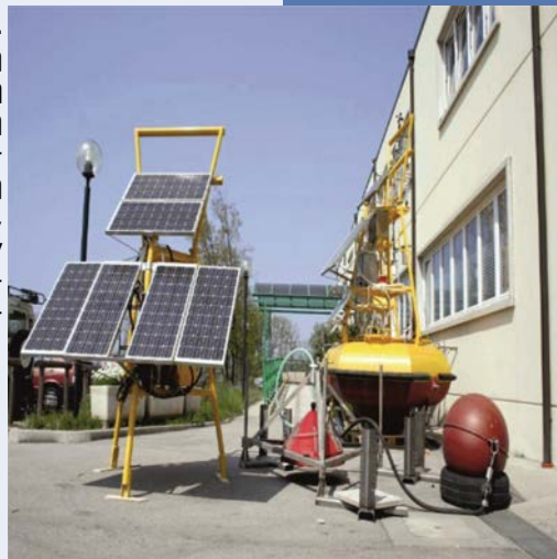
Σχήμα 2 Σημαντήρας παρακολούθησης με ηλιακά πάνελ για παροχή ενέργειας, πλωτήρες και συσκευή δειγματοληψίας αερίου στον πυθμένα της θάλασσας.
