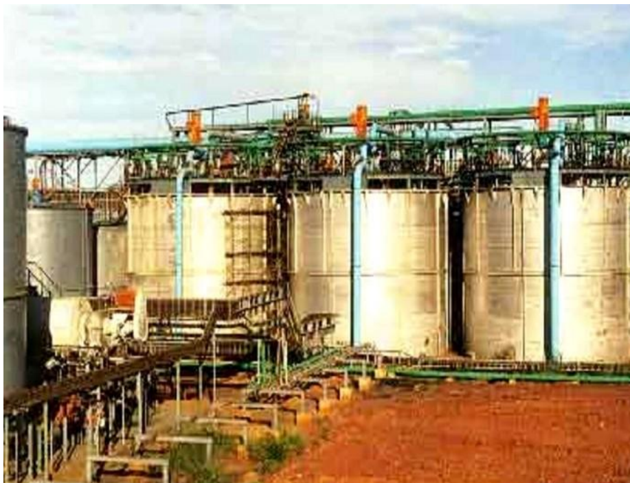
Εικόνα 18: Βιοεχύλιση σε αντιδραστήρες (πηγή BioMinE)
