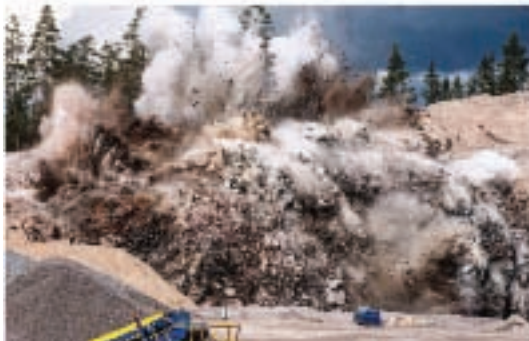
Βίαιη εκτίναξη τεμαχίων Η πιο συνηθισμένη αιτία πρόκλησης ατυχημάτων από ανατινάξεις Πηγή : http://lowvelder.co.za
