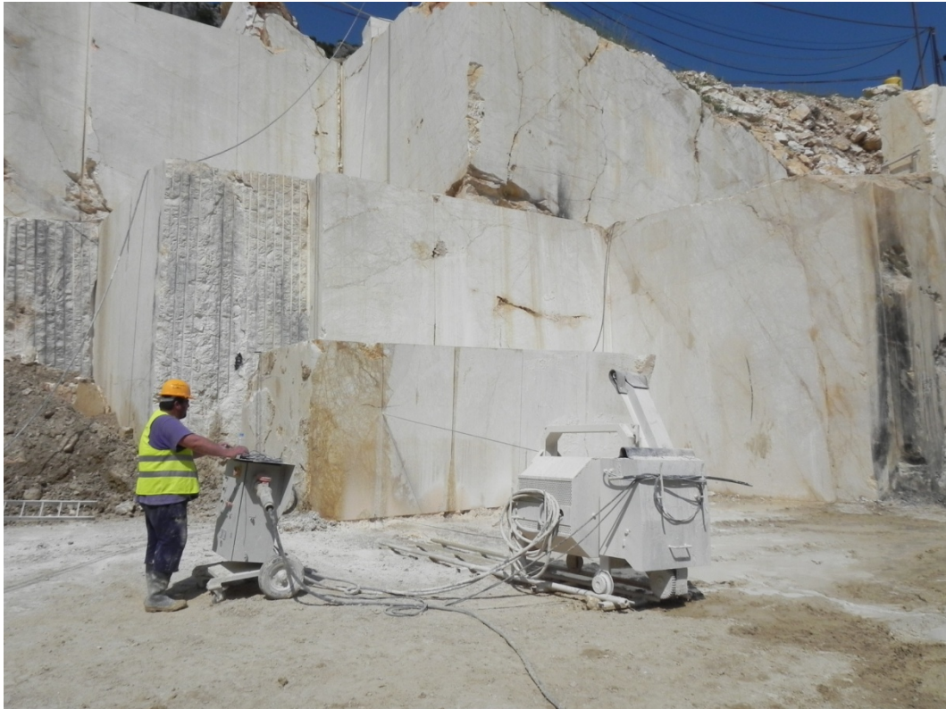
Φωτ. 3: Κοπή πάγκων μαρμάρου με αδαμαντοφόρα μηχανή (συρματοκοπή).
