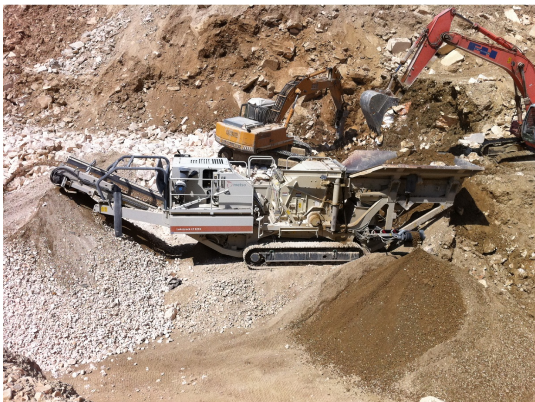
Φωτ.8: Λειτουργία κινητής μονάδας σπαστήρα τύπου Lokotrack.
