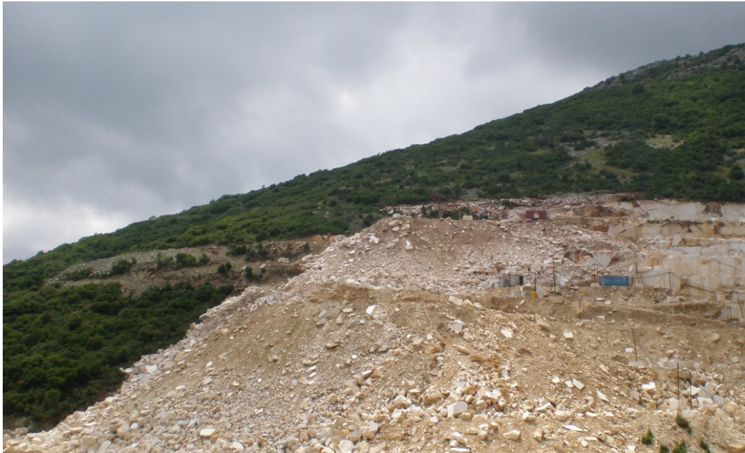
Φωτ. 4: Μη διαμορφωμένη απόθεση στείρων σε αρχικό στάδιο φάσης διανοίξεων.
