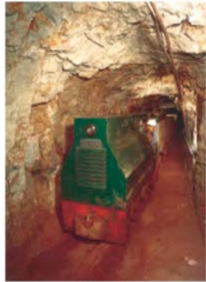
■ Μεταλλείο Είλευσίνας. Ντιζελμάζα υπόγειας μεταφοράς βωξίτη. (αρχείο ΕΛΜΙΝ)
