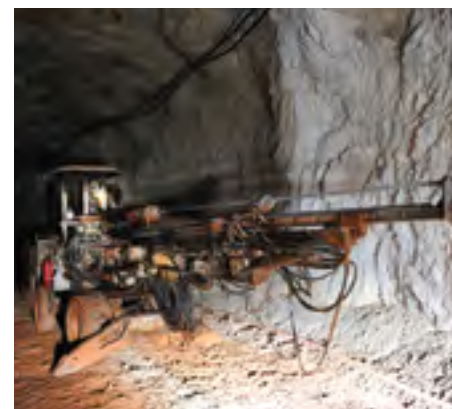
■ Υδραυλικό διατρητικό φορείο υπογείων. «Δελφοί Δίστομο ΑΜΕ»
