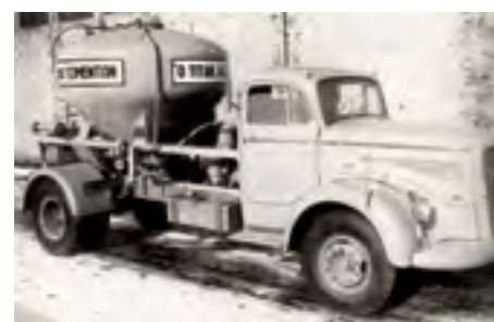
■ Δεκαετία 1950. Σιλοφόρο όχημα τύπου Μερσεντές, ένα από τα πρώτα ιδιόκτητα μεταφορικά μέσα της Εταιρείας με ωφέλιμο φορτίο πέντε τόνους
