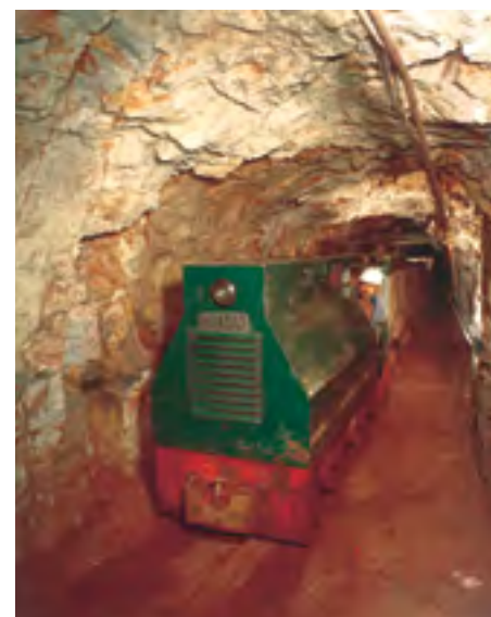
■ Μεταλλεία Ελευσίνας. Ντιζελάμαξα υπόγειας μεταφοράς βωξίτη. (αρχείο ΕΛΑΜΙΝ)
