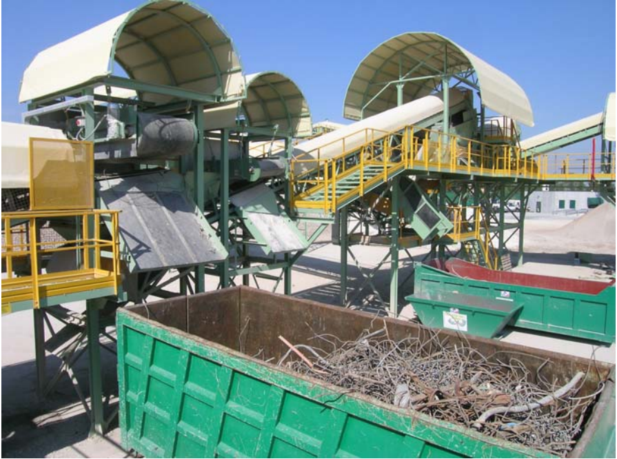
Εικόνα 3.7: Μαγνητικός διαχωριστής σε σταθερή μονάδα ανακύκλωσης στην Πίζα, Ιταλία. Το μαγνητικό προϊόν ανακτάται ως μεταλλικό scrap (ANPAR, 2003).
