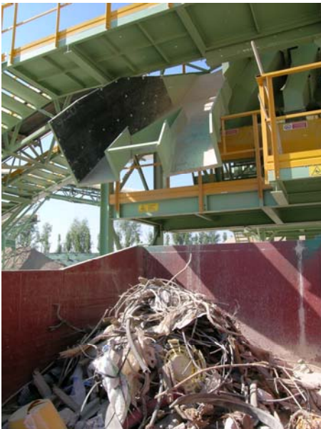
Εικόνα 3.7: Μαγνητικός διαχωριστής σε σταθερή μονάδα ανακύκλωσης στην Πίζα, Ιταλία. Το μαγνητικό προϊόν ανακτάται ως μεταλλικό scrap (ANPAR, 2003).
