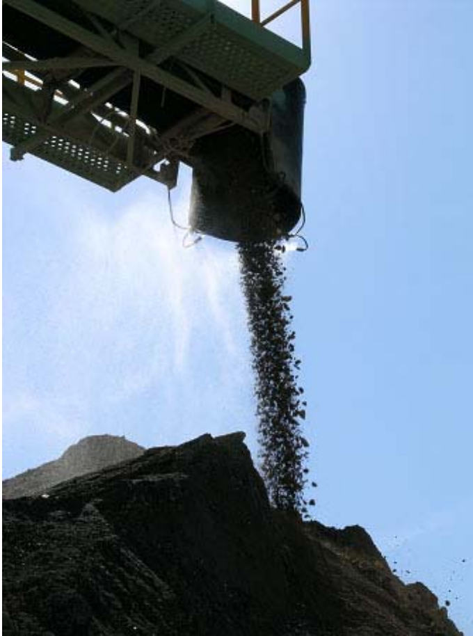
Εικόνα 4.1: Παραγωγή ανακυκλωμένων αδρανών: τελική αποθήκευση σε σωρό (ANPAR, 2003)
